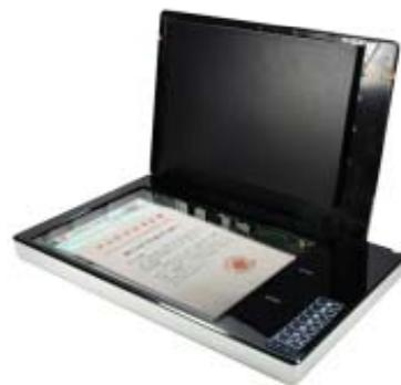
此产品内置多种光源，一机多用。除了像普通扫描仪一样扫描处理常用办公文档，还额外附加UV紫外和IR红外光源，通过激发含有隐形荧光墨水，显现肉眼无法直接看到的稿件内的隐藏信息，并且可以直接存档。可用于印章、票据、文档等的防伪检测。
