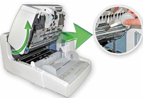
滚轮拆装简单易行，可更大地提高使用效率，延长设备寿命。
